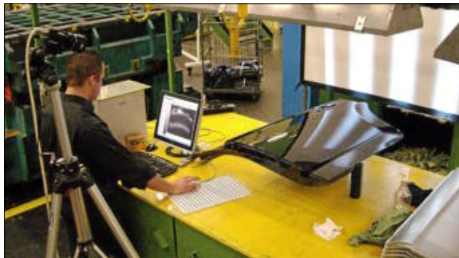
● Sans aucun contact, la technologie de Visuol technologies permet de réaliser les contrôles qualités pointus. DR
